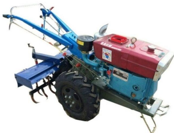
شكل (5) ساحبة ذات قدرة صغيرة بعجلتين
